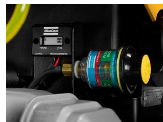
Počítadlo motohodín a indikátor vzduchového filtra
